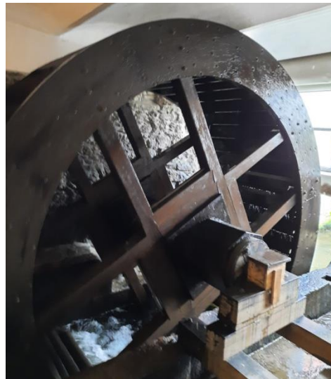
Bild 1: ökologische Durchgängigkeit und Wasserkraftnutzung sind im Einklang – historische Wassermühle mit 30 PS Wasserrad und Fischwanderhilfe – erneuerbarer Grundlaststrom für 50 Haushalte bei 120.000 kWh Jahreserzeugung möglich
